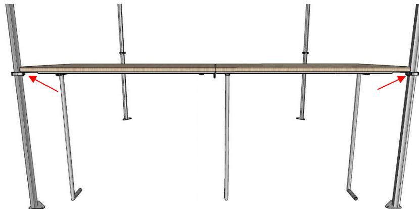
**ETAPE 5** : Ajuster la hauteur en desserrant les vis des colliers de connexion jusqu'à ce que le comptoir repose bien au sol, puis resserrer les vis des colliers.
