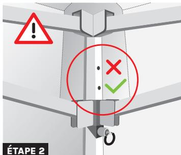
**Attention!** Verrouiller les goupilles des hauts de pied dans le trou inférieur, ne pas utiliser le trou supérieur.
